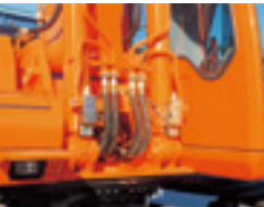
Válvula de protección contra la ruptura de las mangueras de la pluma y el brazo.
